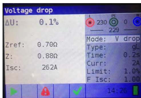
Figura 5 -37 9: Ejemplo de resultados de medición de caída de tensión
