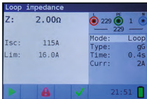
Figura 4 23: Ejemplo de resultados de la medición de la impedancia de bucle
